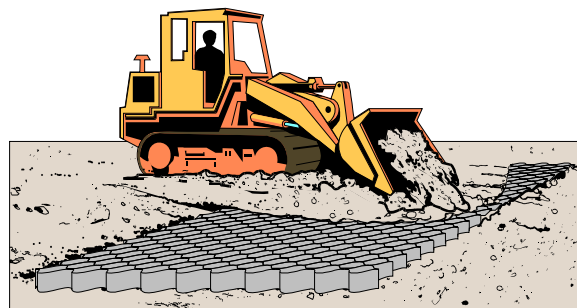
Figura 11 Colocación de Relleno con Cargador
