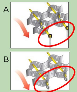
**9. Coloque el relleno desde la parte superior de la pendiente. Utilice equipos adecuados para la colocación de relleno.**
