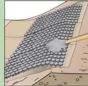
**A. Mantillo y manta de control de erosión**
