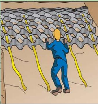
**7. Conecte las secciones de Geoweb con llaves ATRA. Conecte lado con lado (A) y extremo con extremo (B).**
