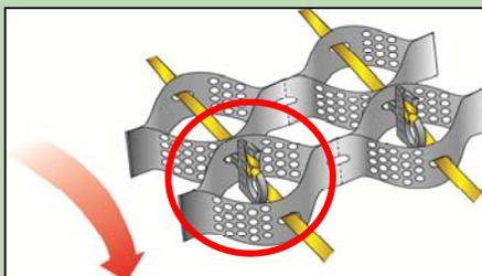
**CONSEJO:** Instálelos en la parte superior de la pendiente con las secciones de Geoweb parcialmente expandidas y de a varias secciones por vez.
