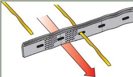
4. Asegure las secciones de Geoweb con tensores en la parte superior de la pendiente con el sistema de anclaje especificado. Vea las opciones A, B, C.
