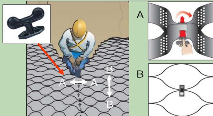
**8. Instale los anclajes en la parte inferior (base) de la pendiente.**
