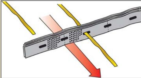
4. Asegure las secciones de Geoweb con tensores en la parte superior de la pendiente con el sistema de anclaje especificado. Vea las opciones A, B, C.
