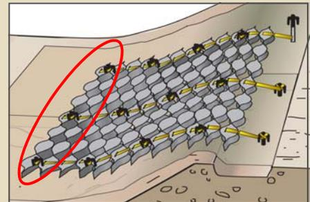
10. Coloque el relleno desde la parte superior de la pendiente. Utilice equipos adecuados para la colocación de relleno.
