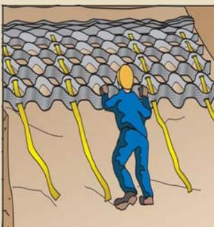
6. Fije la Geoweb en la terminación corriente arriba.
