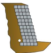
Los muros GEOWEB® pueden diseñarse como taludes empinados cuando se requiere una protección de fascia simple sobre un terraplén de suelo estructuralmente estable.
