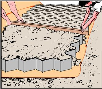
9. Instale las capas Geoweb según lo especificado. Asegúrese de que haya un mínimo de 50 milímetros de retranqueo.
