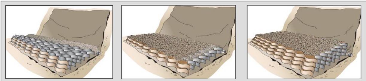
**11.** Aplique semillas a mano (A) o mediante el método de hidrosiembra (B).
