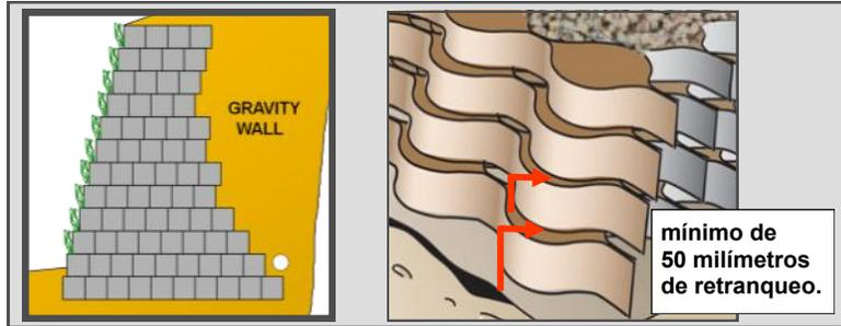
**10.** Instale las capas Geoweb y rellénelas según lo especificado.
