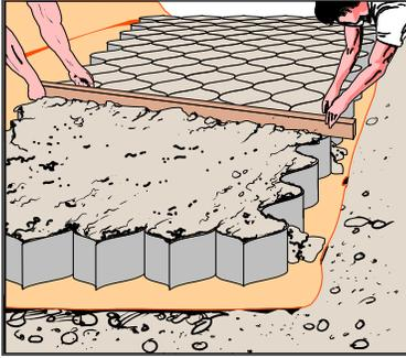
**9.** Instale las capas Geoweb según lo especificado. Asegúrese de que haya un mínimo de 50 milímetros de retranqueo.
