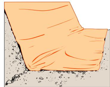
Figura 1 Colocación del Geotextil
